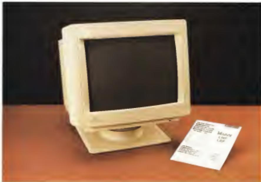
do di assicurare una ridotta emissione di radiazioni sono molte e per la serie di prodotti che identificano una bassa intensità dei campi magnetici ed elettrostatici emessi, sono state create due diciture: LMF e LEF, significano, rispettivamente, Low Magnetic Field e Low Electrostatics Field.
